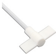
RSO-E 22 mieszadełko pokryte PTFE, 4wiosełko, średnica 70 mm, średnica trzpienia 6 mm, długość trzpienia 350 mm
