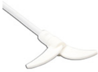
RSO-E 23 mieszadełko pokryte PTFE, śruba odśrodkowa, średnica 90 mm, średnica trzpienia 6 mm, długość trzpienia 350 mm
