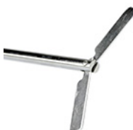
RSO-E 20 mieszadło pokryte PTFE, 4 ostrza, średnica 65 mm, średnica trzpienia 6 mm, długość trzpienia 350 mm
