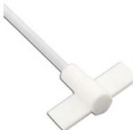
RSO-E 21 mieszadełko pokryte PTFE, 2 ostrza, średnica 70 mm, średnica trzpienia 6 mm, długość trzpienia 350 mm
